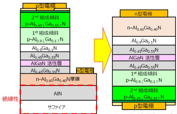
図1 横型半導体レーザー (従来構造)
